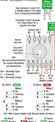
No Alarm GREEN Relay 1 RED Relay 1 GREEN Relay 1 — 8 NC — • 8 NC ⊸ 7 Com. ⊸ 7 Com. ⊸ 7 Com. \_ 6 NO - 6 NO \_₀ 6 NO **GREEN** Relay 2 **GREEN Relay 2** RED Relay 2 -∘11 NC --∞11 NC ----011 NC ₀10 Com. ₀10 Com. Ł - 9 NO A -₀ 9 NO ▲ ⊸ 9 NO
